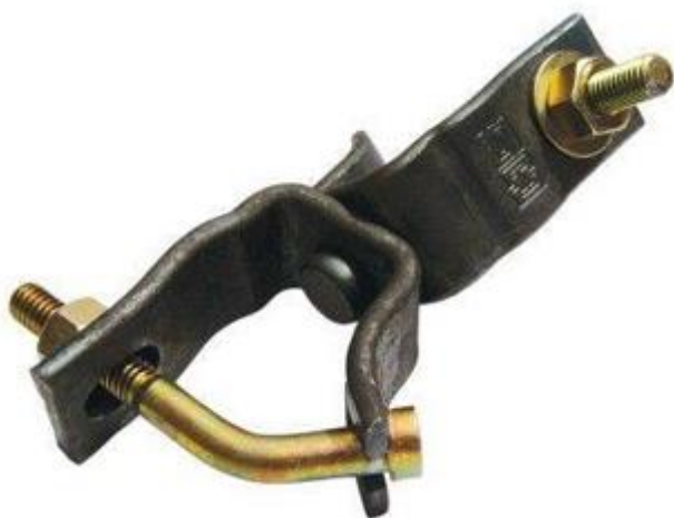
A2 - Braçadeira giratória de aço galvanizado para tubos de 2 ½", fabricada em Aço SAE 5160. Utilizada para união de tubos em qualquer ângulo. https://grupomtorre.com.br/pagina-basica/andaimes-tubo-roll
