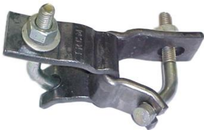
A1 - Braçadeira fixa de aço galvanizado para tubos de 2 ½", fabricada em Aço SAE 5160. Utilizada para união de tubos em ângulo reto. https://grupomtorre.com.br/pagina-basica/andaimes-tubo-roll
